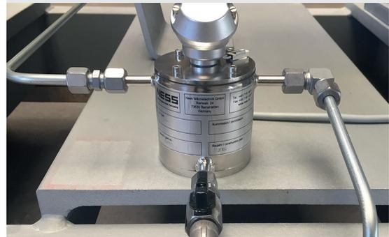
Angeschlossene Leckage-Überwachung (NPCL)
