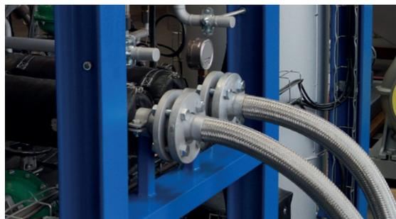
Mit den Wellrohrschläuchen des mobilen Sets, lässt sich die Mietversion der NALD250-i flexibel einbinden
