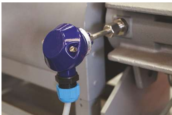
Bild 19.40 Die Überwachung der Lagertemperatur lässt Rückschlüsse auf den Verschleiß zu.
