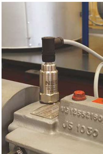
Bild 19.38 Der Vibrationssensor hilft, schwerwiegende Schäden zu vermeiden. [Quelle: NESS]
