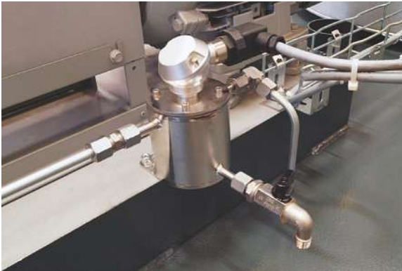
Bild 19.37 Die Leckageüberwachung basiert auf einer Füllstandsmessung der Leckage an der Gleitringdichtung der Pumpe.
