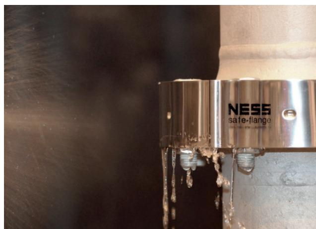
Sécuriser correctement les systèmes de tuyauterie qui contiennent des liquides inflammables, chauds, toxiques ou caustiques, c'est un must, surtout s'ils sont sous pression. Si des défauts d'étanchéité apparaissent sur les raccords à bride, ces liquides peuvent être projetés à travers la pièce, blesser des collaborateurs ou endommager gravement l'installation.
